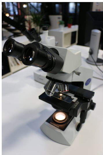
Figure 4 - Microscope d'observation à immersion (x1000) – Laboratoire ArkéoMap.
