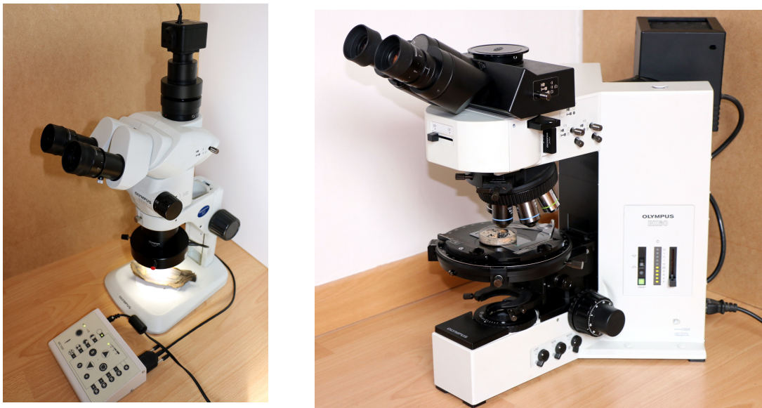
Figure 1 - Stéréomicroscope OLYMPUS SZX7 et microscope d'observation OLYMPUS BX60 utilisés
