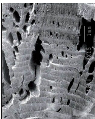
Figure 10 – Exemple de fentes de retrait sur un charbon de conifère (Marguerie et al. , 2010).
