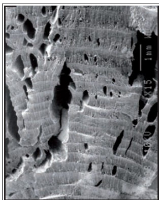
Fig. 8 – Exemple de fentes de retrait (Marguerie et al. , 2010).
