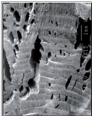
Fig. 9 – Exemple de fentes de retrait (Marguerie et al. , 2010).
