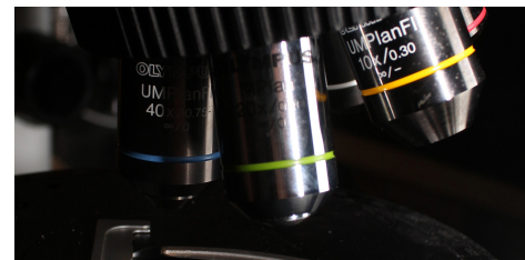
Fig. 3 - Détails du microscope équipé d'un dispositif en lumière incidente (Olympus BX60 à grossissements x50 à x1000). Laboratoire ArkéoMap.
