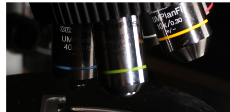
Figure 3 - Détails du microscope équipé d'un dispositif en lumière incidente (Olympus BX60 à grossissements x50 à x1000). Laboratoire ArkéoMap.
