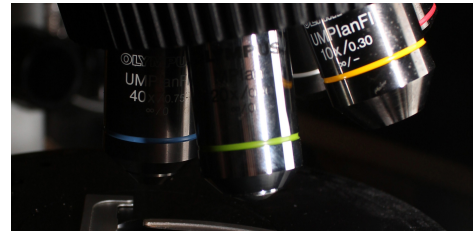
Fig. 4 - Détails du microscope équipé d'un dispositif en lumière incidente (Olympus BX60 à grossissements x50 à x1000). Laboratoire ArkéoMap.
