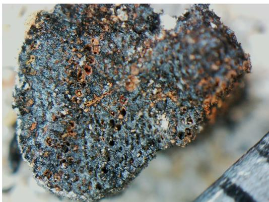
Fig. 29 – Fragment d'orme (*Ulmus sp.*). Coupe transversale. Grossissement x22. Prélèvement US6/US7. L'échelle représente des millimètres.
