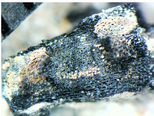
Fig. 43 – Fragment de saule (*Salix sp.*) de forte courbure. Coupe transversale. Grossissement x24. Prélèvement n°191. L'échelle représente des millimètres.
