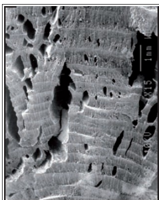
Fig. 7 – Exemple de fentes de retrait (Marguerie et al. , 2010).
