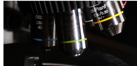
Fig. 3 - Détails du microscope équipé d'un dispositif en lumière incidente (Olympus BX60 à grossissements x50 à x1000). Laboratoire ArkéoMap.
