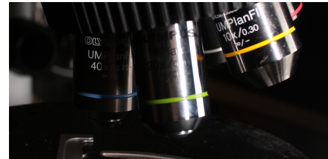
Fig. 2 - Détails du microscope équipé d'un dispositif en lumière incidente (Olympus BX60 à grossissements x50 à x1000). Laboratoire ArkéoMap.
