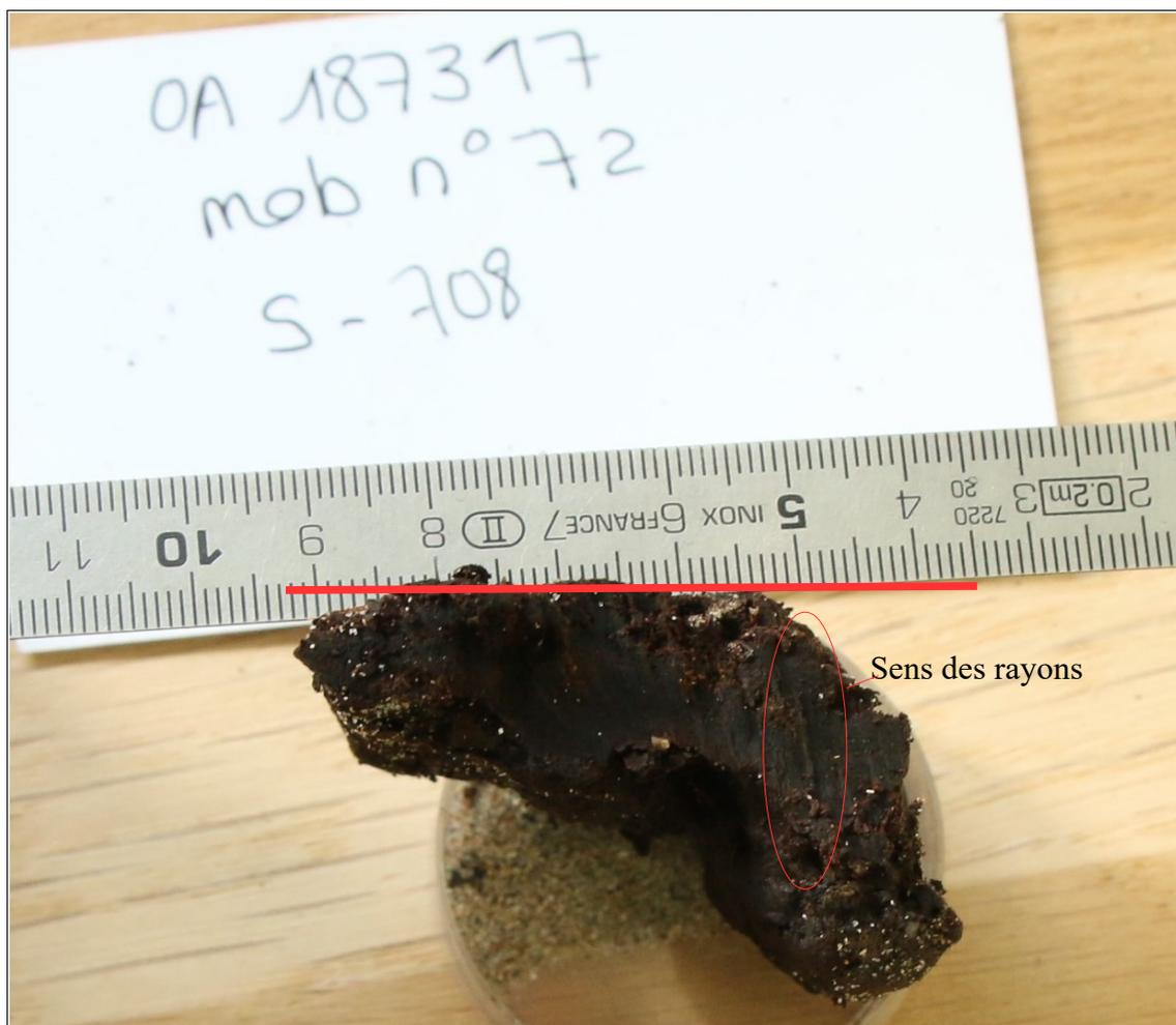
Fig. 13 – Vue en coupe transversale montrant un bois à zone poreuse avec des rayons multisériés (visibles) typiques du chêne. Le bois semble avoir été équarri ou écorcé, le plan de coupe est symbolisé par le trait rouge. L'échelle représente des millimètres. Prélèvement n°72.
