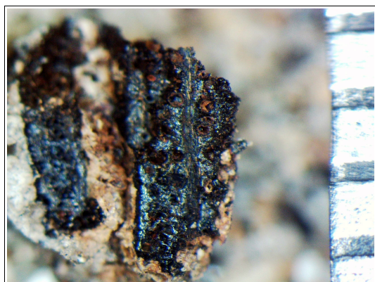
Fig. 39 – Fragment de chêne ( Quercus sp. ) d'aspect « fendu-luisant » et de forte courbure de cerne. Coupe transversale. Grossissement x23. Prélèvement n°2. L'échelle représente des millimètres.
