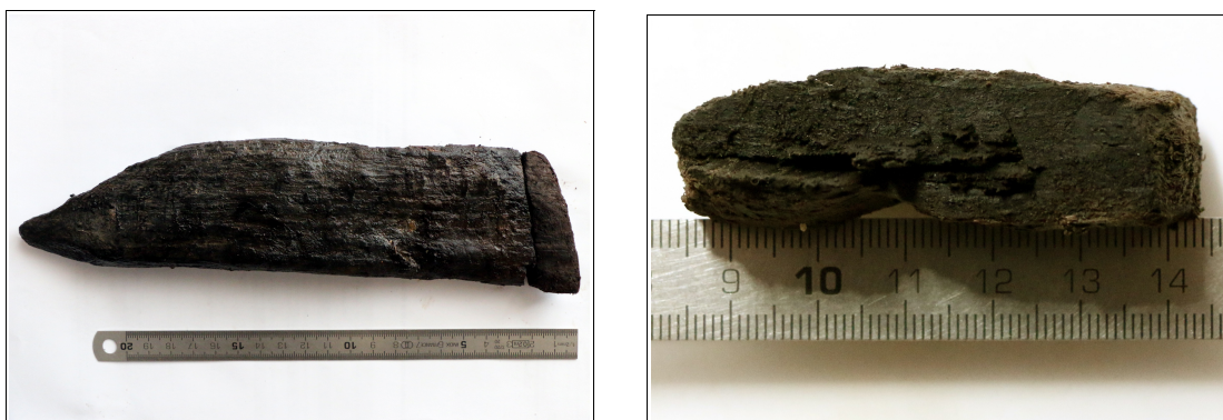
Fig. 17 – Image de gauche : Vue de la douelle sur le plan radial. Image de droite, coupe transversale au niveau de la cassure, les cernes sont peu visibles mais on distingue le sens des rayons en partie « parallèles » au plan de débitage de la pièce de bois.
