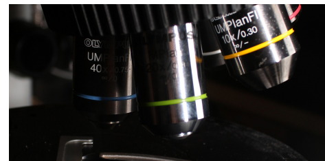
Fig. 5 - Détails du microscope équipé d'un dispositif en lumière incidente (Olympus BX60 à grossissements x50 à x1000). Laboratoire ArkéoMap.
