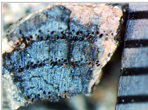
Fig. 99 – Fragment de frêne de forte courbure de cerne, d'aspect « dur-luisant ». Prélèvement 66 (ST2000). Grossissement x20. L'échelle représente des millimètres.
