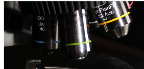
Figure 2 - Détails du microscope équipé d'un dispositif en lumière incidente (Olympus BX60 à grossissements x50 à x1000).
