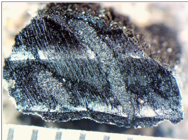
Fig. 90 Traces de galeries (vermoulures) de la petite vrillette (*Anobium punctatum*). Fragment de sapin (*Abies sp.*) en coupe transversale. Prélèvement P02-1206.
