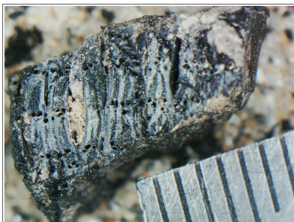
Fig. 21 Coupe transversale d'un fragment de chêne de forte courbure de cerne, avec des fentes de retrait sur la partie extérieure (Prélèvement n° 4).
