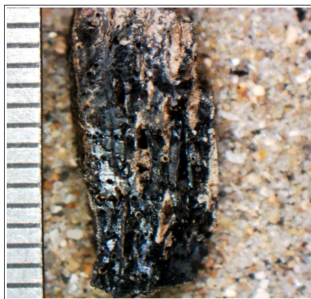
Fig. 22 Coupe transversale d'un fragment de chêne d'aspect « fendu-luisant » (Prélèvement n° 6).
