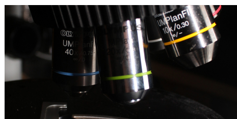
Figure 5 - Détails du microscope équipé d'un dispositif en lumière incidente (Olympus BX60 à grossissements x50 à x1000). Laboratoire ArkéoMap.
