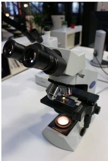
Figure 1. Microscope d'observation (x1000).
