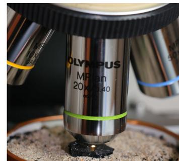
Fig. 4 - Détails du microscope équipé d'un dispositif en lumière incidente (Olympus CX40 à grossissements x50 à x500) et d'une caméra numérique. Laboratoire ArkéoMap.
