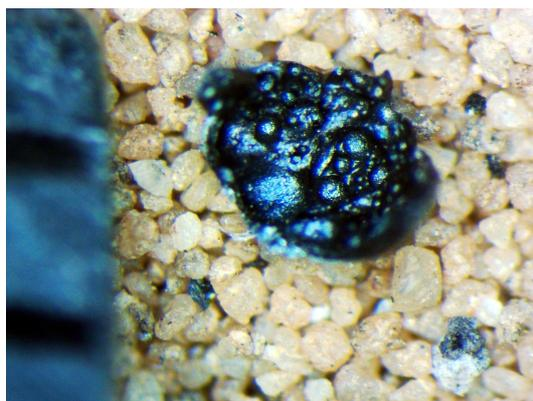
Fig. 68 – Face intérieure de ce qui ressemble à une « battiture ou sphère de carbone ». Aspect fondu-luisant. US 258. grossissement x43.
