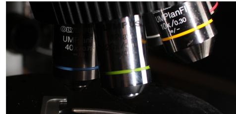
Fig. 2 - Détails du microscope équipé d'un dispositif en lumière incidente (Olympus BX60 à grossissements x50 à x1000). Laboratoire ArkéoMap.
