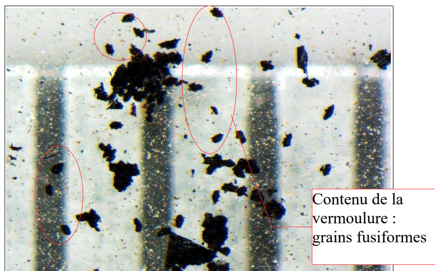
Fig. 36 Exemples de « grains fusiformes » retrouvés à l'intérieur des vermoulures du fragment de sapin. Prélèvement n°37.2, grossissement x20, l'échelle représente des millimètres.
