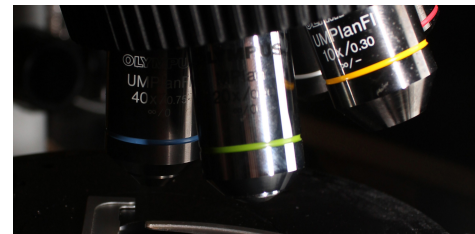
Figure 4 - Détails du microscope équipé d'un dispositif en lumière incidente (Olympus BX60 à grossissements x50 à x1000). Laboratoire ArkéoMap.
