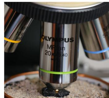
Figure 4 - Détails du microscope équipé d'un dispositif en lumière incidente (Olympus CX40 à grossissements x50 à x500) et d'une caméra numérique. Laboratoire ArkéoMap.
