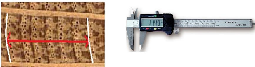
Figure 5 – Illustration du principe des mesures de largeurs de cernes : vue macroscopique d'une coupe transversales de chêne avec sélection d'un ensemble de largeur de cernes. Un pied à coulisse est ensuite utilisé pour effectuer les mesures sous loupe binoculaire (photos ArkéoMap).
