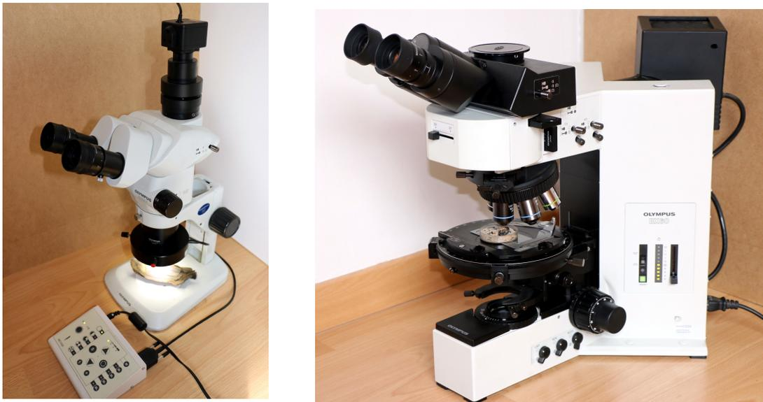
Figure 1 - Stéréomicroscope OLYMPUS SZX7 et microscope d'observation OLYMPUS BX60 utilisés au laboratoire ArkéoMap.
