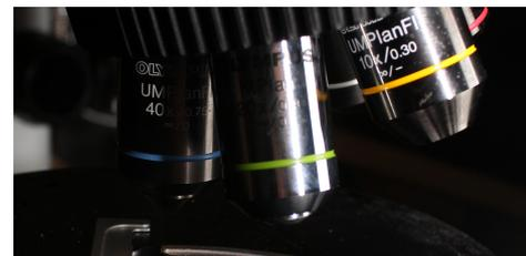
Figure 4 - Détails du microscope équipé d'un dispositif en lumière incidente (Olympus BX60 à grossissements x50 à x1000).
